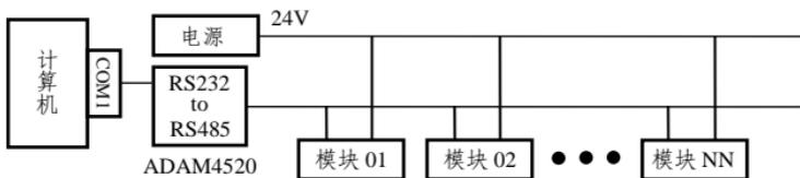
图 11 采集模块连接图
