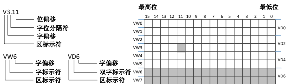
图5-2-1变量寻址示意图
