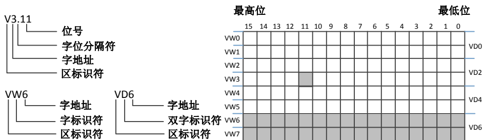
图5-2-6 变量寻址示意图
