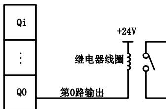
图 4-2-10 数字量输出接线方法
