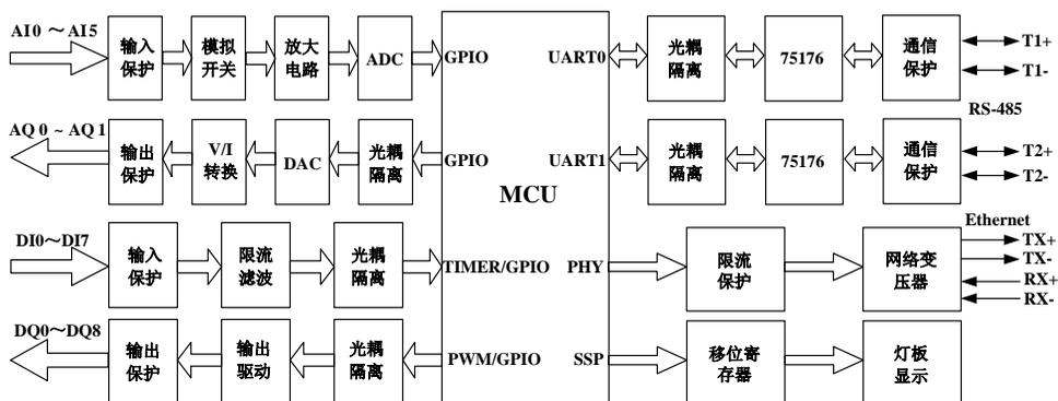
图 2-1-1 EDC8000 原理框图
