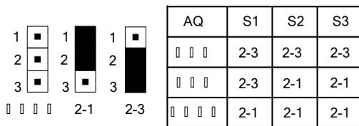
图 4-2-14 AQ 输出选择内部跳线
