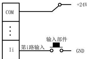
图 4-2-16 数字量输入接线方法
