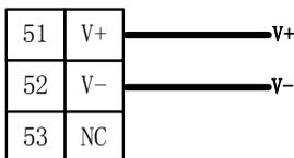
图 4-2-6 电源端子接线方法
