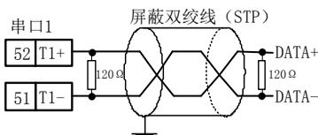
图 4-2-8  $120\Omega$ 匹配电阻的接线方法
