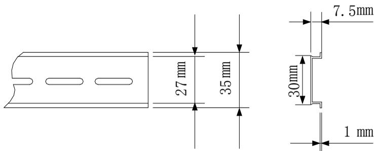
图 4-3-1 导轨外观尺寸
