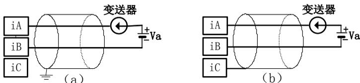
图 4-2-13 电流型无源输入接线方法
