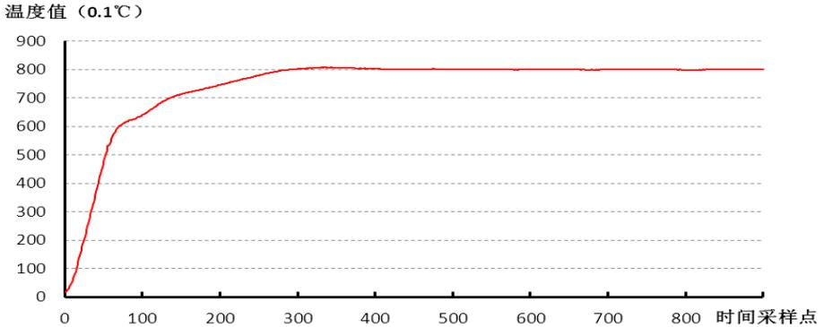
图 5-2-7 P\_PID 无过冲自整定控温曲线图
