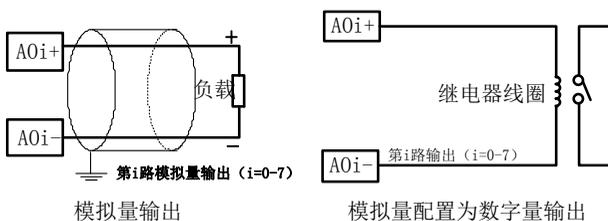
图 4-2-15 模拟量输出接线方法
