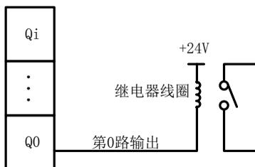
图 4-2-17 数字量输出接线方法
