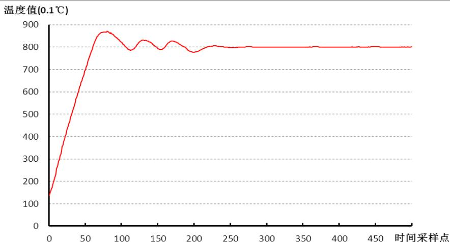
图 5-2-6 P\_PID 有过冲自整定控温曲线图
