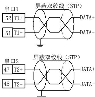
图 4-2-7 串口接线方法
