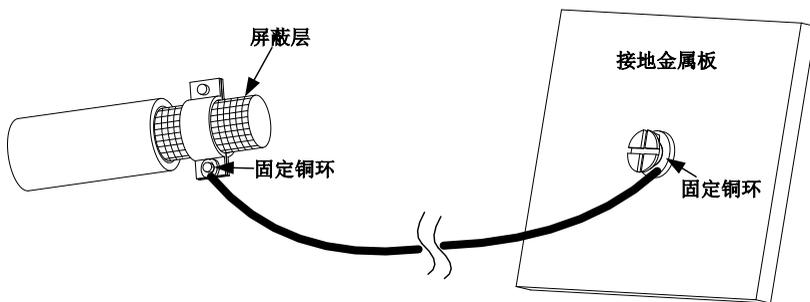
图 4-2-5 电缆屏蔽层的接地方法
