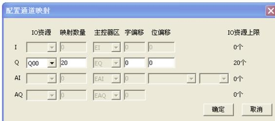
图 3-3-4 IO 模块变量区映射界面
